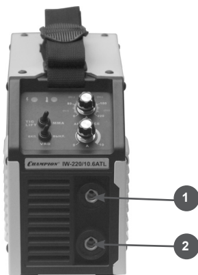
Рис. 4. Места установки сварочных кабелей
