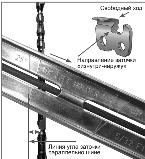
Рис.22 Определение угла заточки
