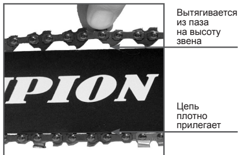
Рис. 5 Регулировка натяжения цепи
