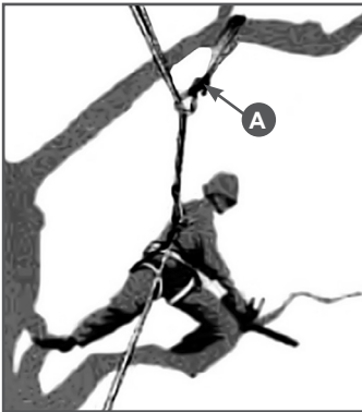
Рис.17 Положение оператора при горизонтальном пилении
