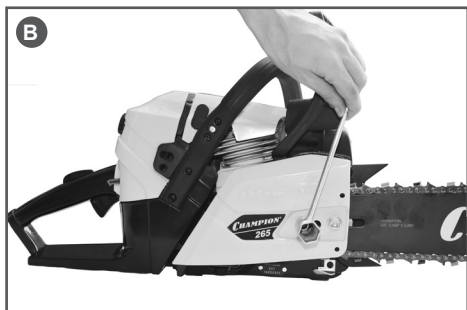
Рис. 5 Затяжка гайки крепления шины
