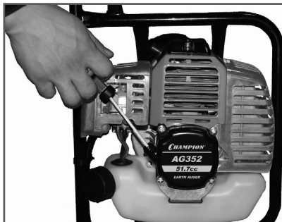
Рис. 7 Свободный ход шнура стартера
