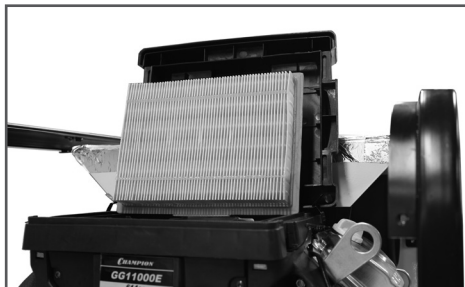
Рис. 14 Обслуживание воздушного фильтра
