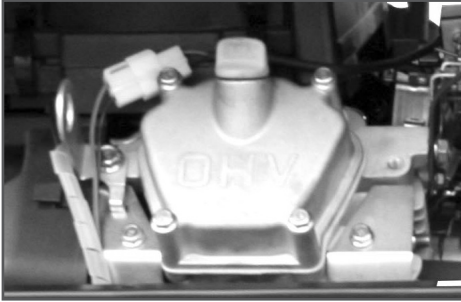
Рис. 8 Пробка маслоналивного отверстия в крышке клапанов
