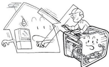
**Устанавливать генератор от горючего материала на расстоянии 1 м минимально**
