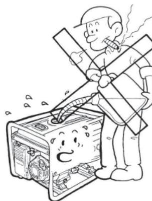
**При заправке топливом не допускать разлива топлива**
