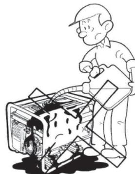
**При заправке топливом обязательно заглушить двигатель**
