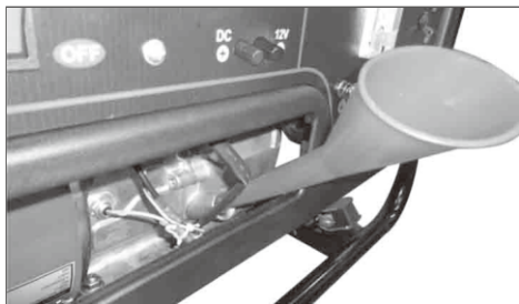
Рис. 7 Заправка масла в картер двигателя
