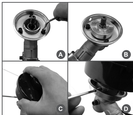
Рис.6 Установка триммерной головки
